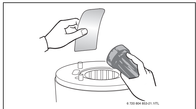
sl. 66 Provera toplotnog bloka u pogledu ostataka
