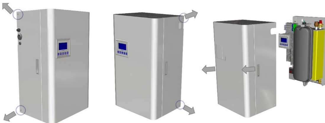
Slika 5. Otvaranje kotla (demontaža prednjeg omotača kotla)
